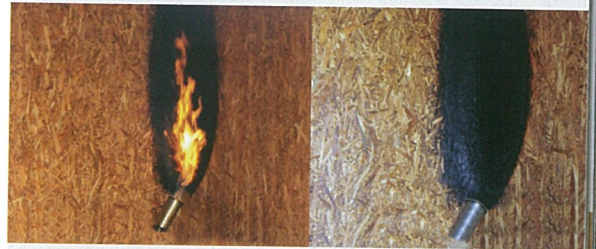
KRONOPLY OSB SF-B bildet bei Beflammung eine feuerfeste Schicht durch Verkohlung.
