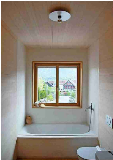
Edler Schimmer: Die Wände im Badezimmer sind mit traditionellem Kalkputz beschichtet. Dieser ist wasserabweisend und verleiht ihnen einen leichten Glanz
